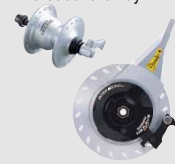
Bubnová brzda s modulátorem účinku
