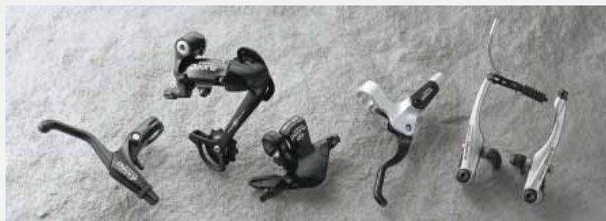
Možnost zadního měniče DEORE Top normal a jednotek řazení RAPIDFIRE Plus.
